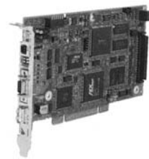
MP2100基板 型号: JAPMC-MC2100 大致重量: 135g
